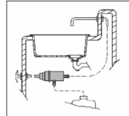
La válvula de medición reduce el desperdicio y la suciedad al dosificar la MISMA cantidad de solución para fregar a CADA vez, independientemente de la cantidad de solución remanente en el recipiente.
